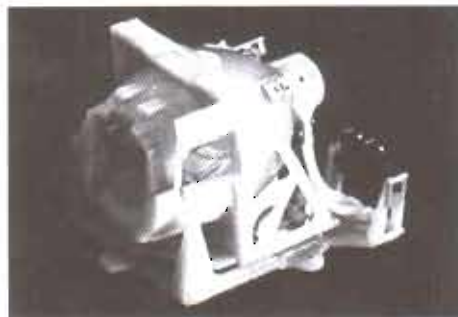
图7 PPSF 材料的车灯灯架原型，可以耐高温测试。
