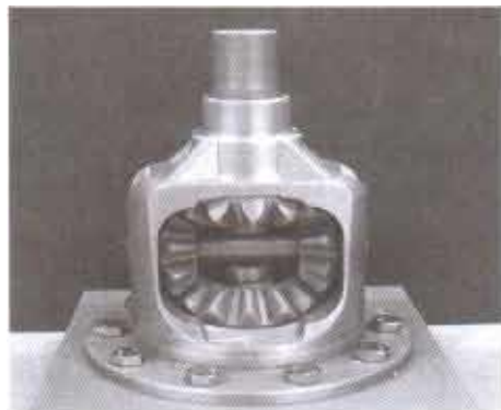
图10 PPSF 材料的仿真汽车差速器。
